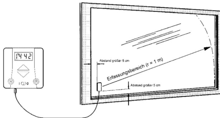
Für die Zusatzfunktion „Glasbruchmelder“ wird zu jeder Rolladensteuerung *jollymatic 95.1 G/S* ein (bei größeren oder geteilten Scheiben mehrere) Glasbruchmelder benötigt. Im nachfolgenden Text wird beschrieben, wie die Installation durchgeführt wird.
